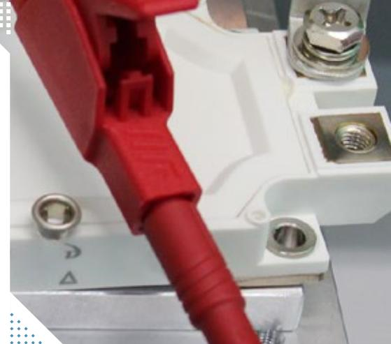
Общий вид IGBT-модулей на измерительном стенде, при проведении дополнительного 100% контроля на сдвоенный импульс для оценки динамического поведения на предельно допустимом токе коллектора.
