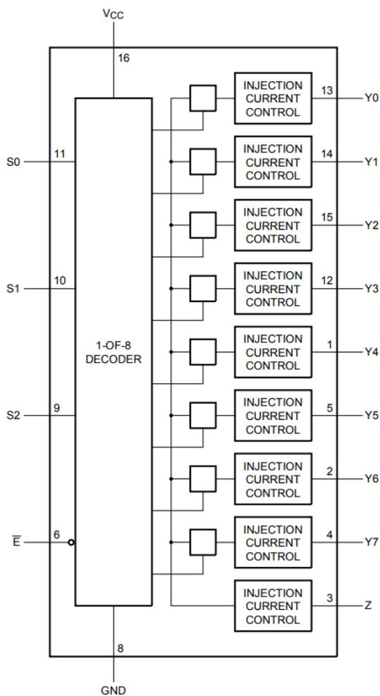
рисунок 1 – Схема функциональная
