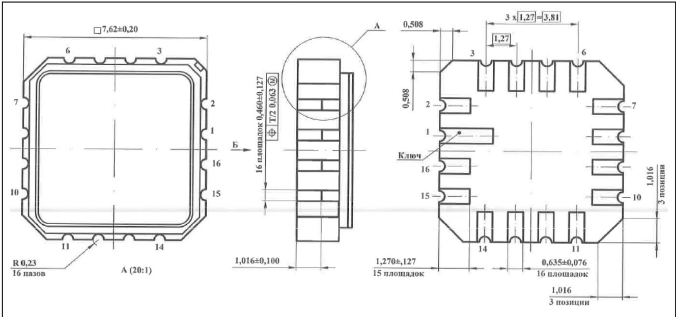
Корпус SOP-16 (4307.16-A) (16 выводов), металлополимерный
