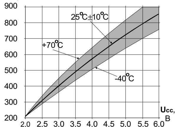
**Зависимость выходного напряжения по выводам MASK, XMITMUTE и DP от тока нагрузки и температуры**
