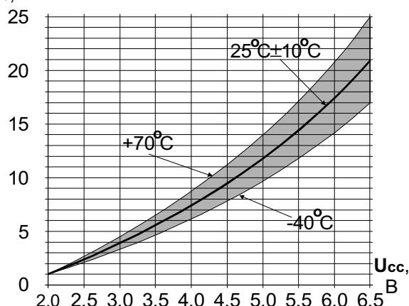
**Зависимость динамического тока потребления при импульсном наборе от напряжения питания и температуры**
