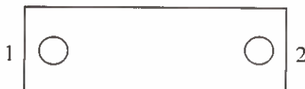
Порядок затягивания винтов: 1 – 2
